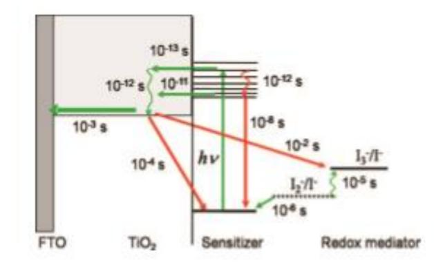
Key efficiency parameters of a DSSc :
